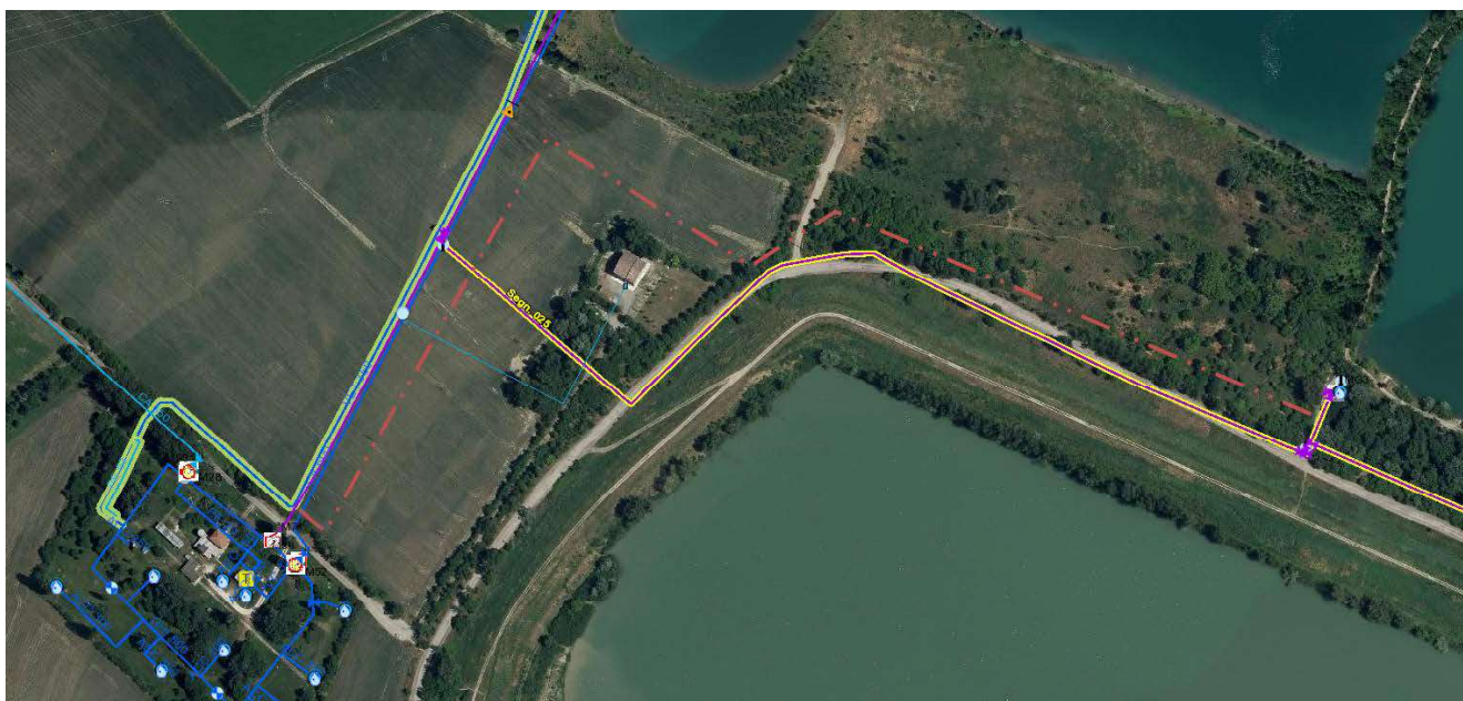
Di colore giallo/rosso la rete esistente che verrà eliminata, di colore rosso tratteggiato la nuova rete in progetto
